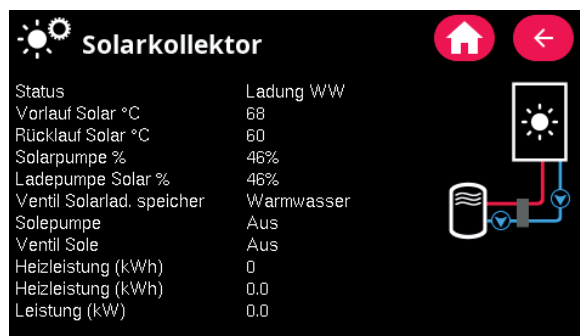
Menü „Betriebsinfo Solarkollektoren“.
